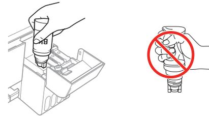
**Nota:** La tinta fluye en el tanque y se detiene automáticamente cuando llega a la línea superior del tanque. Si la tinta no fluye de la botella, levante y vuelva a insertar la botella.
