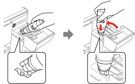
**Nota:** No inserte las botellas por la fuerza; las botellas están diseñadas para funcionar exclusivamente con el tanque de tinta del color correspondiente.
